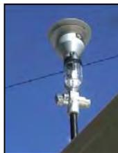
La tête de prélèvement PM10 permet un échantillonnage représentatif des fractions de particules pouvant pénétrer dans le système respiratoire des bronches supérieures. Elle sépare les poussières selon leur granulométrie et ne sélectionne que les particules de diamètre inférieur à 10µm (PM10).
